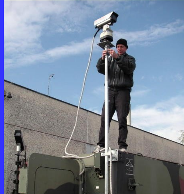
MINTRON MTV-12V6HC-EX TAMRON 4-12 mm pred. 6 mm Asphérique F1.2 DC Iris Angle de Vision H: 62,2° V: 50.3°
