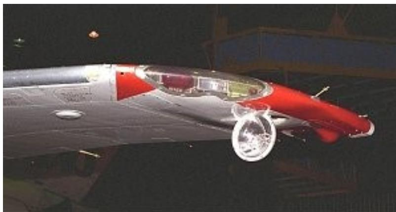
*Disposition rapprochée des divers feux situés en bout d'aile sur les MD80/90 - [Source](#)*
