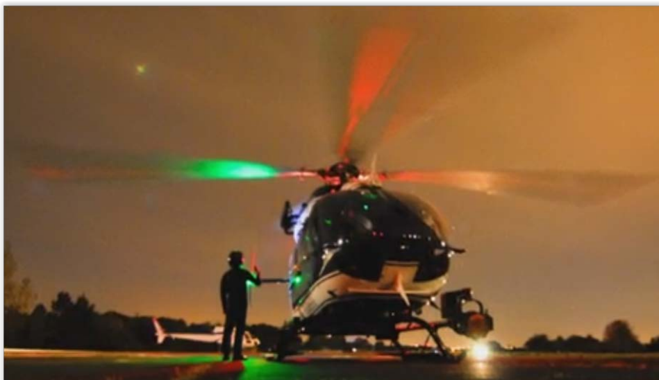
Hélicoptère EC145 de la Gendarmerie au décollage sur la base de Vélizy-Villacoublay - On notera le phare de recherche SX16 (éteint) sur la gauche de l'appareil, puissance 1600 Watts, capable d'éclairer un stade de football à 300 m de distance ( source )
